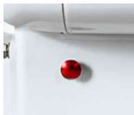
Switch de parada de emergencia
